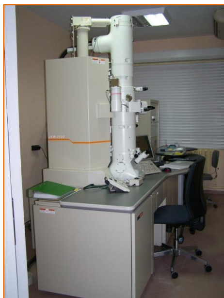
TEM JEOL JEM 2100, Le Laboratoire de microscopie électronique, L'Institut des Matériaux et Technologies Optiques "Académicien Jordan Malinovski", L'Académie Bulgare des Sciences
