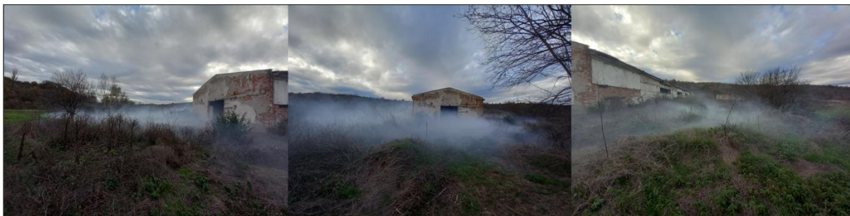
Фиг. 14. Кондензационен облак, формиран след статичен тест на перйодатно гориво.
