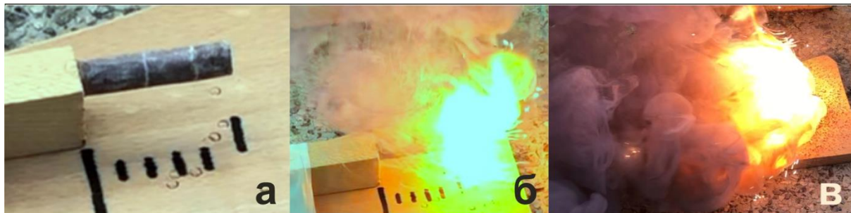
Фиг. 11. Горивен образец с диаметър \varnothing 11 мм (а); горене при атмосферно налягане (б); газоотделяне, оцветено в лилави тонове (в).
