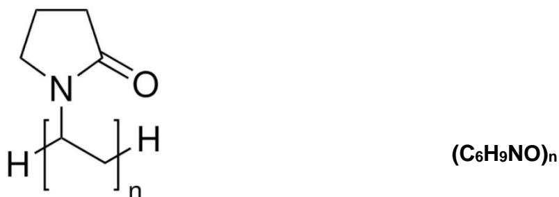
Фигура 45. Химично обозначение на PVP: а) структурна формула и б) химична формула.
