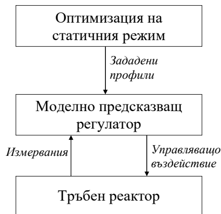
Фигура 4.2 Супервайзорна система за управление
