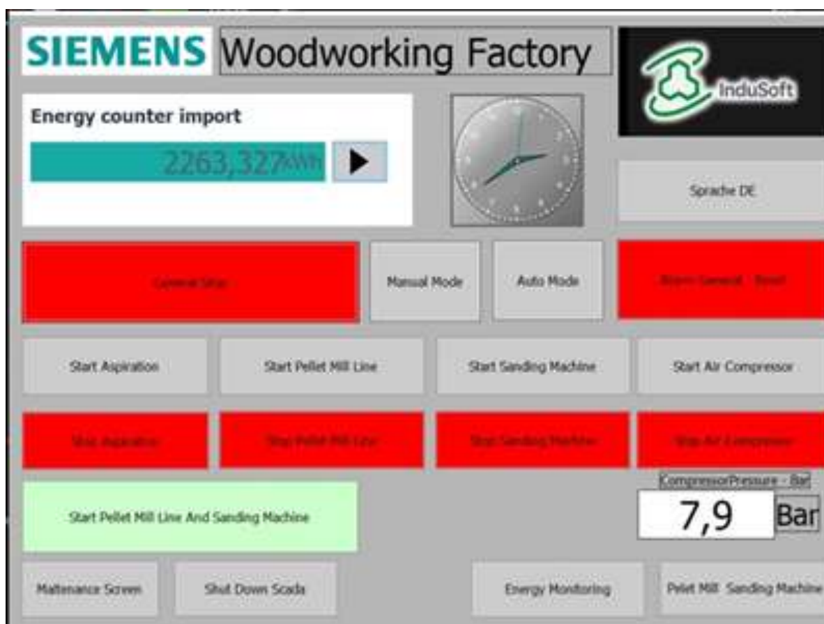
Фиг.16. Главен интерфейс на SCADA системата
